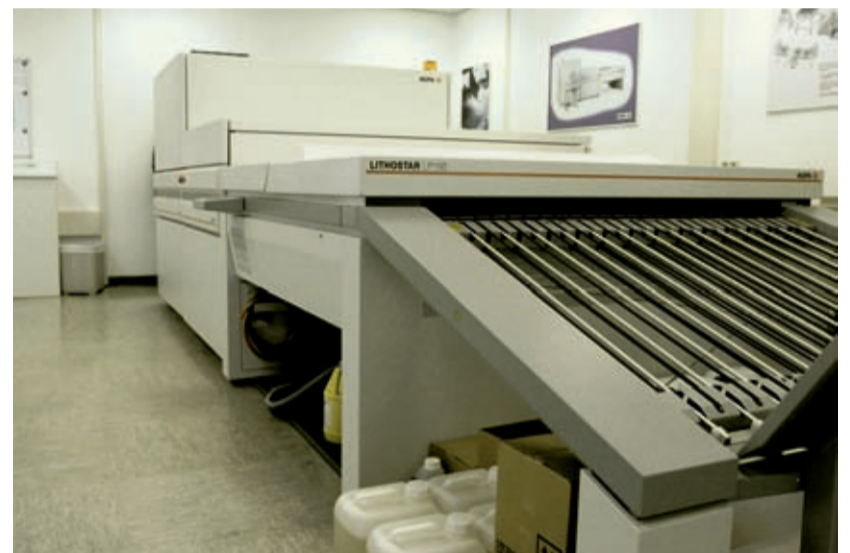
Auch in der Druckvorstufe ist druck-partner auf dem modernsten Stand der Technik: die filmlose Druckplattenherstellung CtP
