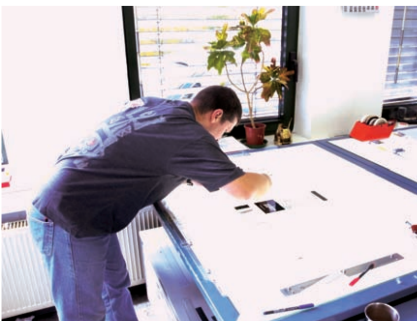
Die Bogenmontage erfordert nach wie vor das fachliche Können eines ausgebildeten Druckformherstellers
